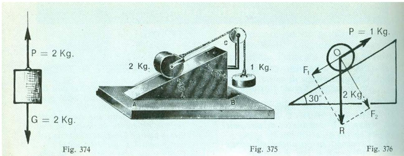
Ecco un cilindro pesante 2 Kg.; se lo sospendi ad una fune come è indicato nella fig. 374, evidentemente, per impedirgli di cadere, dovrai esercitare sulla fune una forza P di 2 Kg., uguale e contraria al peso G del cilindro. Ma prova ad appoggiare il cilindro su un piano inclinato, nel modo indicato in fig. 375; vedrai che per trattenerlo ed impedirgli di cadere (cioè, in questo caso, di scendere lungo il piano) basterà la forza di 1 Kg. Perché?
